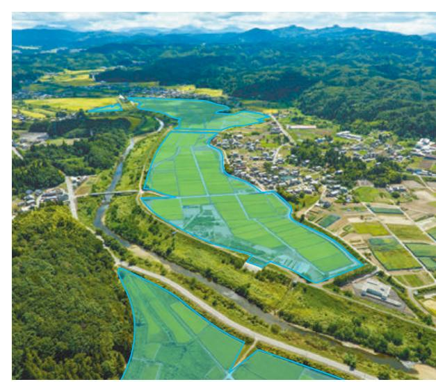
刈谷田川上流付近の遊水地(水色枠内)。堤防の一部が低くなつており、増水時にあふれた水を一時的に農地などへため、下流への流量を抑える仕組み
