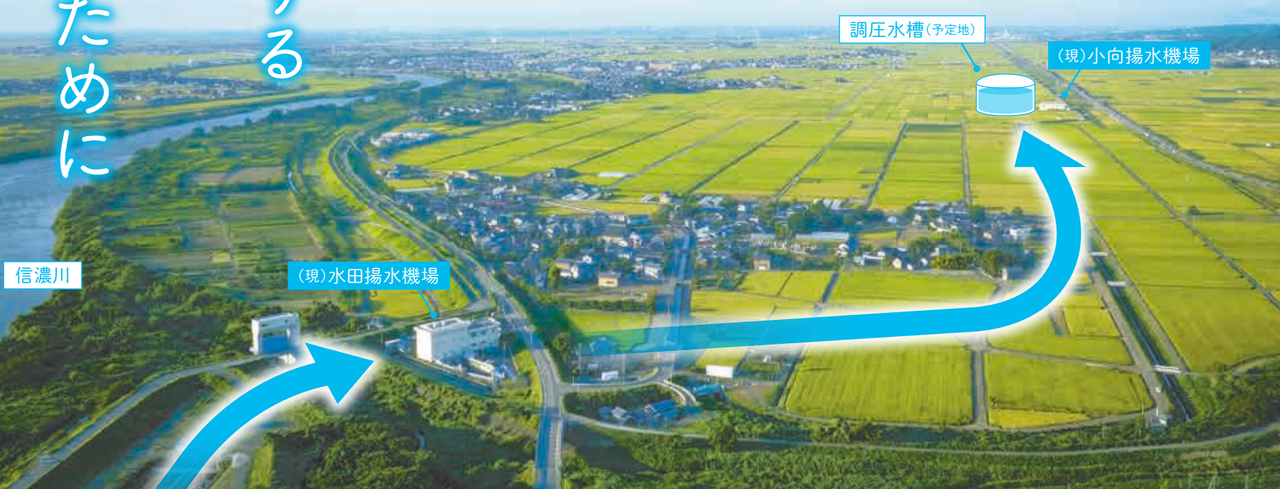
揚水機場でくみ上げた水は、今後、造成される調圧水槽でいったん貯留され、下流で水を使いたい時には、自然流下で流す。「余水」のロスを減らすと同時に、下流域の農業の自由度を上げるというメリットも
