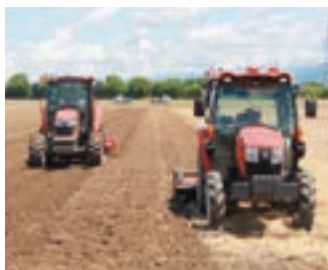
自動運転トラクターを使った大豆の直播作業。1人の人間が直進アシスト機(左)と無人機(右)で同時に作業します
